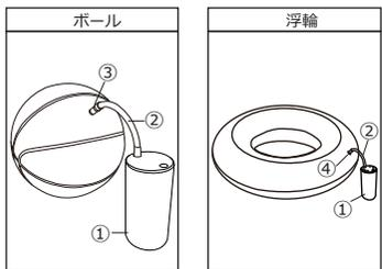
①本体と②チューブ繋いでチューブ先端に③ボール用ノズルを取り付け、ボールの空気穴に差込む
