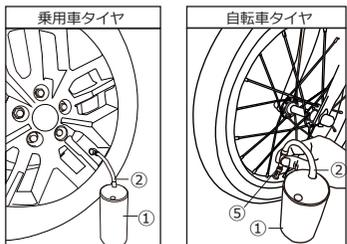
①本体と②チューブ繋いで②チューブ先端黒い部分をバルブのネジに沿って回し込む。
